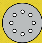
GLS 5 Ø 125 mm 8 agujeros de aspiración Ø 10 mm en círculo de agujeros Ø 65 mm
